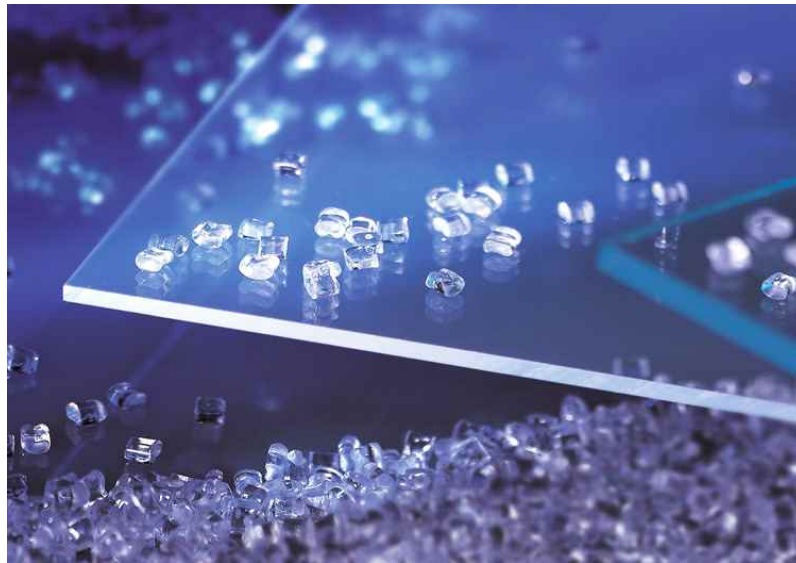
▲ 삼양사가 생산하는 엔지니어링 플라스틱 '폴리카보네이트(PC)'. 투명성 및 내열성이 우수해 전기전자 부품, 자동차 등에 광범위하게 사용된다.
